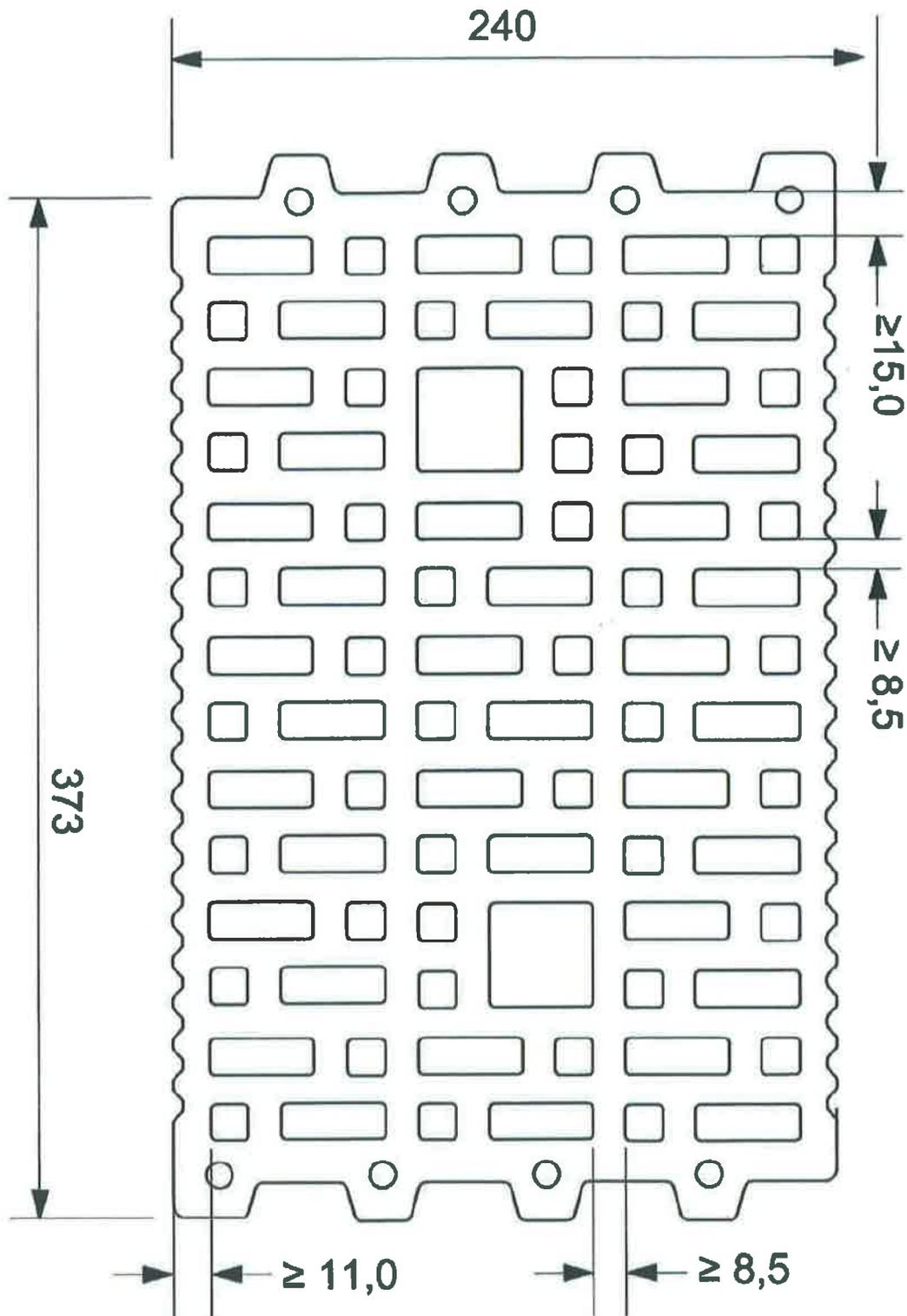
Mauerwerk aus Poroton-Planhochlochziegeln-T der Rohdichteklassen 1,2 und 1,4
