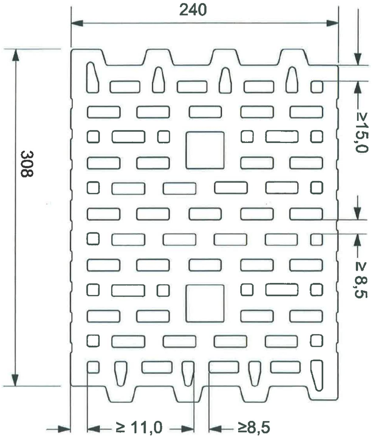
Mauerwerk aus Poroton-Planhochlochziegeln-T der Rohdichteklassen 1,2 und 1,4
